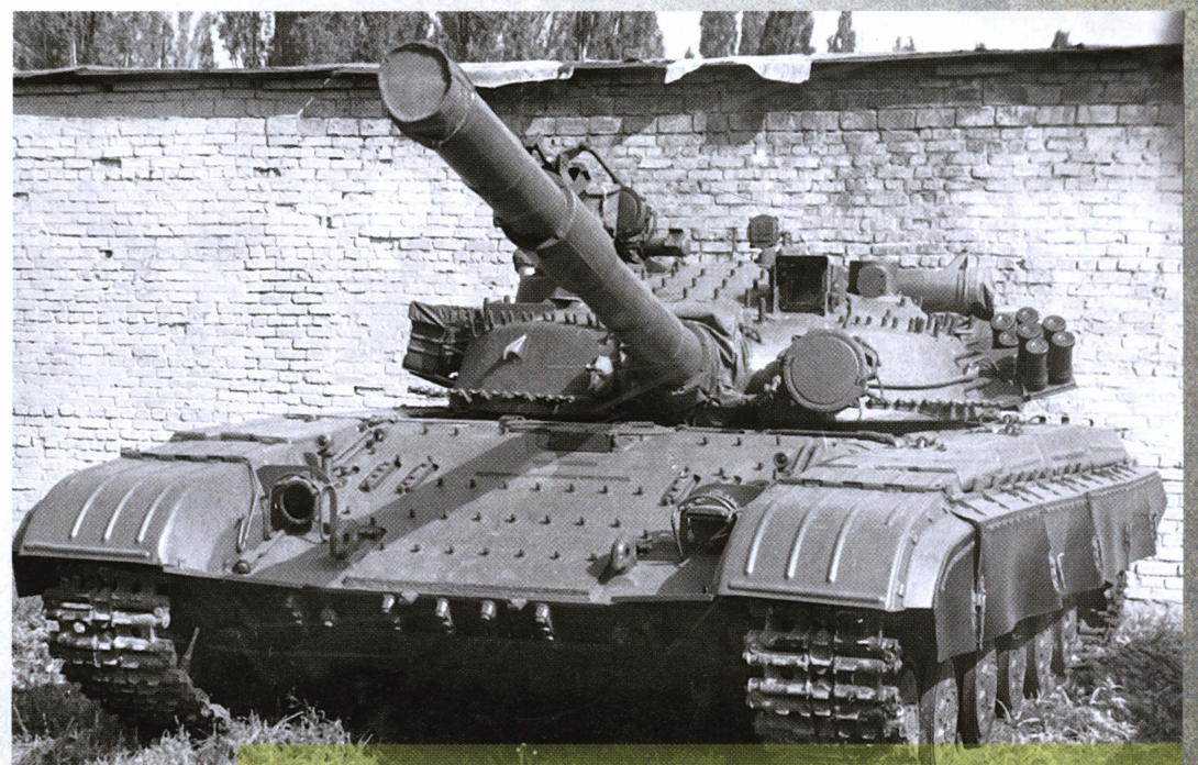
Танк Т-64БВ со снятыми контейнерами динамической защиты «Контакт-1». Хорошо видны крепежные элементы для установки контейнеров.
