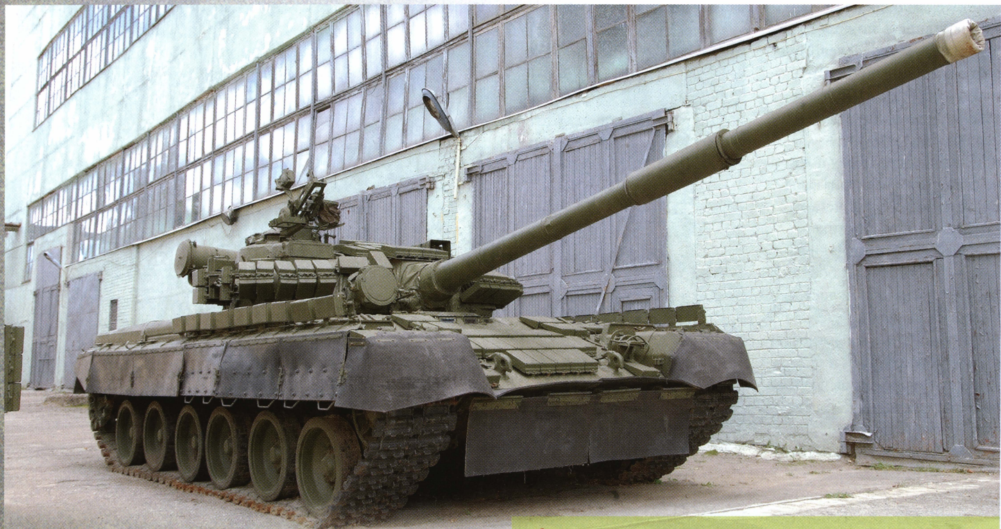
Танк Т-80БВ с динамической защитой «Контакт-1».
