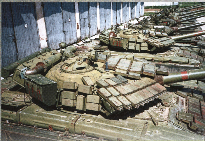
Танки Т-64БВ с установленной динамической защитой «Контакт-1», 1999 год.
