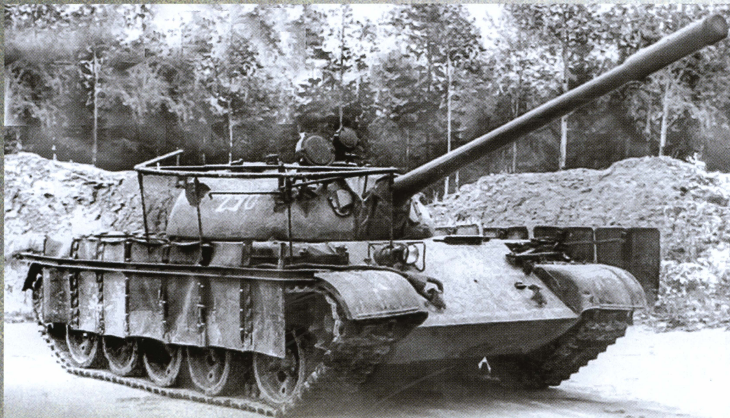
Танк Т-55 с установленным на нем опытным образцом противокумулятивного экрана из резиновых листов и проволочной сетки, 1962 год.
