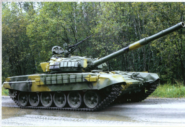
Танк Т-72Б, оснащенный навесной динамической защитой «Контакт-1», 2001 год.
